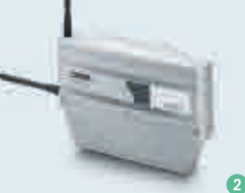
Point d'accès WLAN
