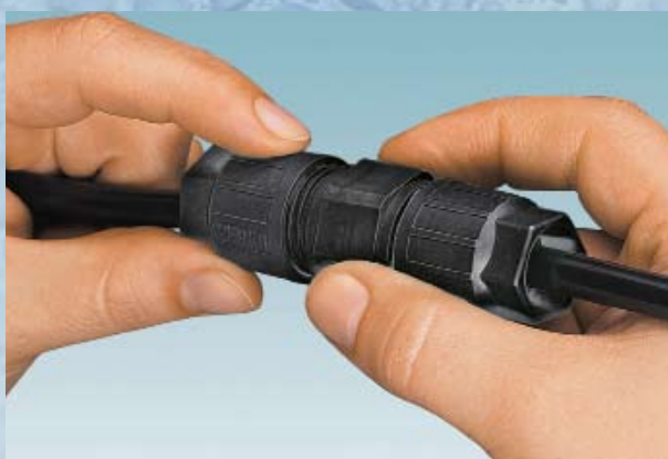
4. Monter l'écrou-chapeau sur le porte-contacts et le serrer avec le couple requis (5 Nm).
